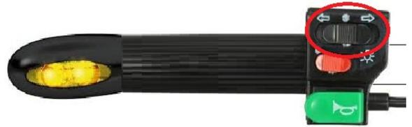
Il peut prendre trois positions : ON à gauche, OFF (au centre) et ON à droite et il reste dans cette position tant qu'il n'est pas manœuvré à nouveau.
