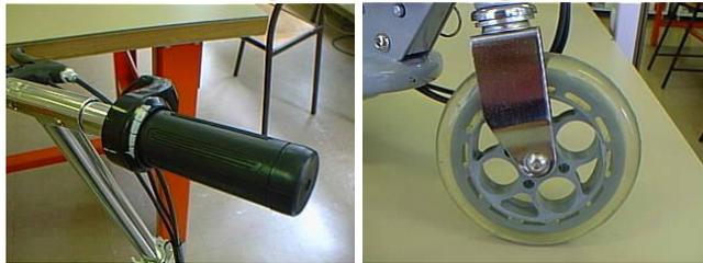
Fonction freinage : L'utilisateur tire la poignée de frein. La poignée tire sur un câble métallique qui passe dans une gaine noire.
