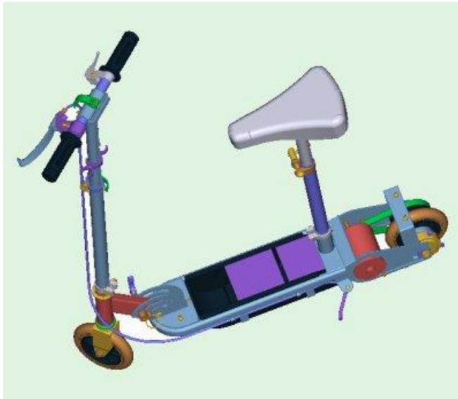
Fonction guidage : L' utilisateur tourne le guidon relié à la potence et la roue avant.
